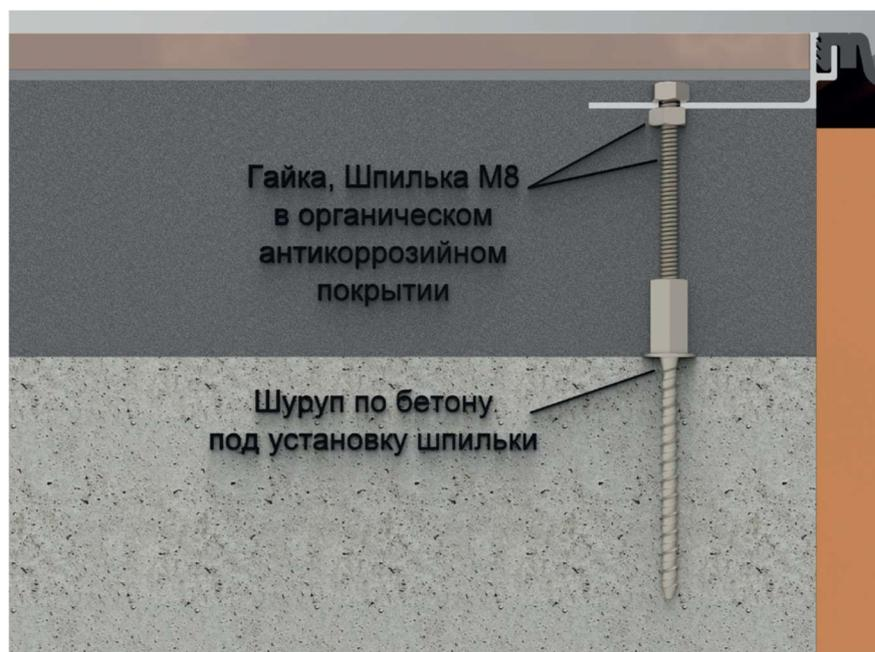
С помощью системы креплений MASTER PROOF MOUNTING можно установить любую конструкцию для деформационных швов MASTER PROOF EXPANSION JOINT с закладной установочной частью на высоту до 250мм!
